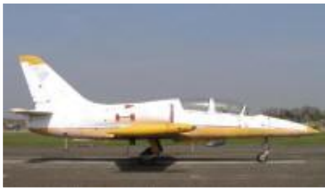
Фото: L-39V (Viесna - буксировочная) - одноместный буксировщик мишеней КТ-04.
