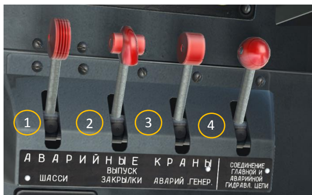
Рис. Краны аварийной гидросистемы
